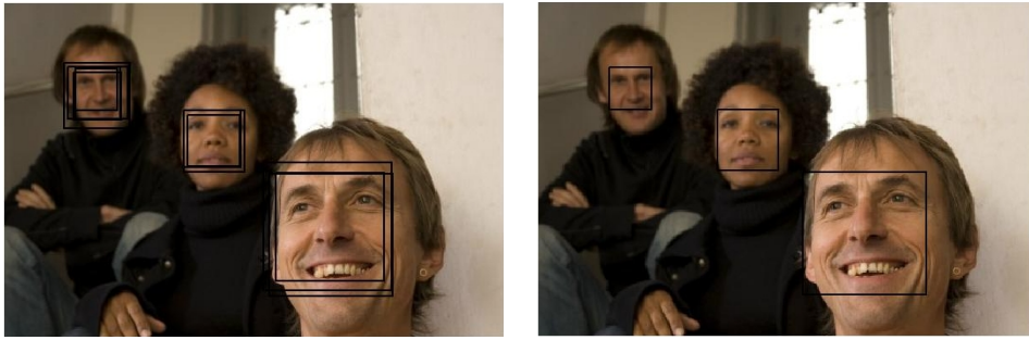
Abbildung 3.11: Ausgabe des Detektors: Im linken Bild ohne die Filterung von überlappenden Detektionen sowie im rechten Bild die Ausgabe des Detektors mit der Nachbearbeitung, die überlappende Detektionen zu einer zusammenfasst.
