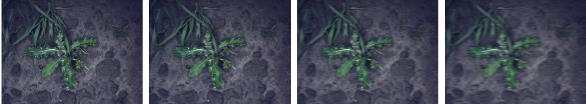
Abbildung 74: Darstellung der verschiedenen simulierten Translationsunscharfen am Beispiel eines Bildes; von links: Original, Integration über 10 Pixel, 20 Pixel, 30 Pixel
