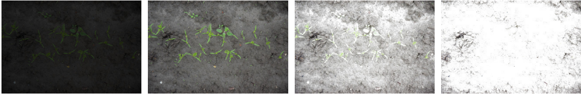
Abbildung 139: Darstellung der verschiedenen simulierten Helligkeitsstufen am Beispiel eines Bildes; Von links: 30%, Original (100%), 200% und 300% Belichtung
